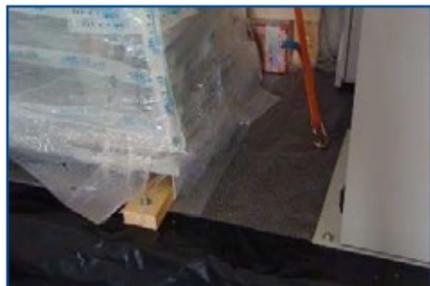
Consiste in attività di posizionamento, staffaggio e fissaggio delle macchine all'interno degli imballi per assicurarne l'integrità del contenuto durante tutte le fasi di movimentazione e trasporto fino a destino e attività di montaggio degli imballi con nostro personale specializzato e relative attrezzature.
