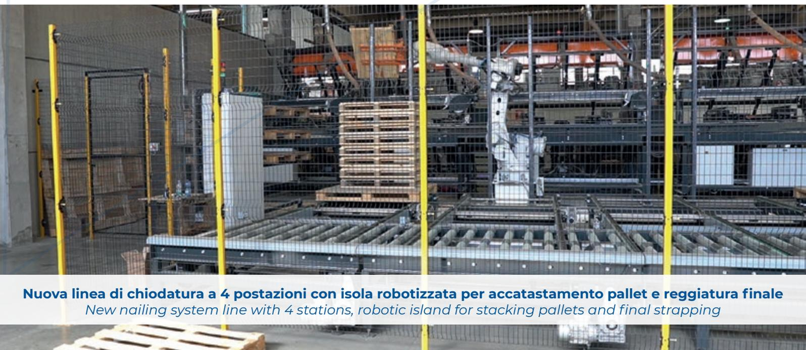
**Nuova linea di chiodatura a 4 postazioni con isola robotizzata per accatastamento pallet e reggiatura finale**
